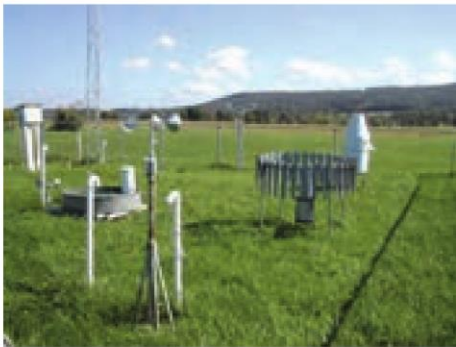
در ایستگاه‌های هواشناسی با استفاده از انواع ابزارها، میزان دما، بارش، رطوبت، سرعت، جهت وزش باد و... به طور دائم ثبت می‌شود.
