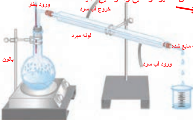
شکل ۲- تقطیر ساده برای جداسازی دو مایعی که اختلاف نقطه جوش
