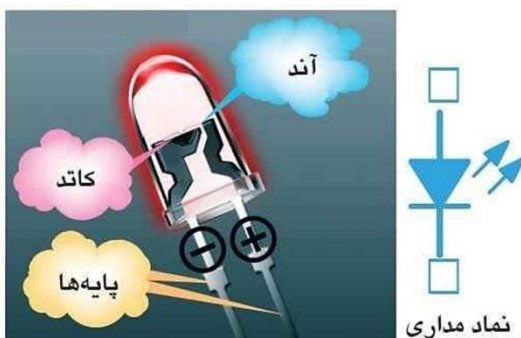
نماد مداری و ساختمان داخلی LED
