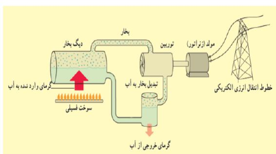
با سوزاندن سوخت های فسیلی باعث گرم شدن آب داخل دیگ بخار و تبدیل آن به بخار می گرددند. بخار به وجود آمده باعث گردش توربین ها می شود. با چرخش توربین ها، مولدی مثل ژنراتور انرژی حرکتی توربین را به انرژی الکتریکی تبدیل می کند. همچنین پس از سرد شدن بخار و تبدیل مجدد آن به آب، این آب به دیگ بخار باز می گردد و چرخه ادامه می یابد.
