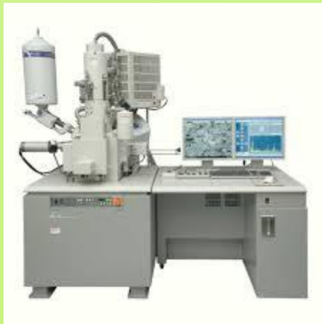
میکروسکوپ الکترونی (قدرت بزرگنمایی ۵۰۰۰۰۰ برابر)
