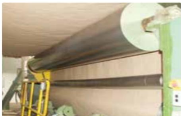
غلتک آهنی برای صاف کردن خمیر کاغذ
