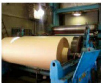
مرحله ششم ، خشک کردن خمیر کاغذ به کمک حرارت و غلتک های آهنی
