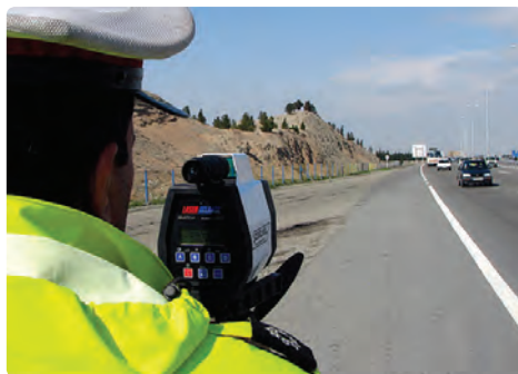
شکل ۳۰-۳ تعیین تندی خودروها به کمک اثر دوپلر
