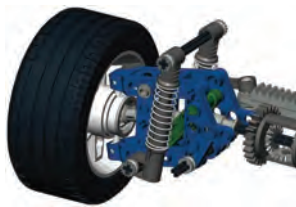
شکل ۲-۱۴ فنرهای به کار رفته در چرخ‌های خودرو
