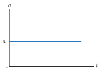
شکل ۱۳-۱ نمودار a-t در حرکت با شتاب ثابت با فرض مثبت بودن a
