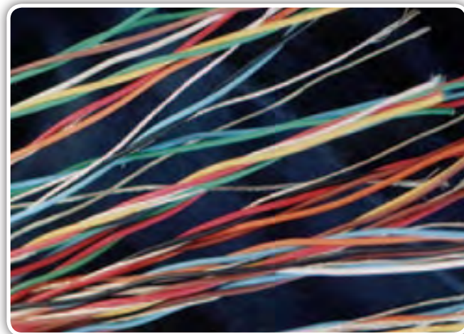
▲ شکل ۲۸-۳) رنگ‌های مختلف کابل‌های تلفن امکان تشخیص خطوط مشترک‌های متفاوت را فراهم می‌سازد.
