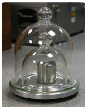
شکل ۱-۷ استاندارد ملی کیلوگرم که نسخه دقیقی از استاندارد بین‌المللی سیور فرانسه است. این نمونه، در مرکز اندازه‌شناسی در سازمان ملی استاندارد ایران نگاه‌داری می‌شود.
