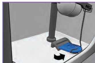
چ - اطمینان از نبودن زنجیر یا هر شیء خارجی در زیر درپوش تخلیه
