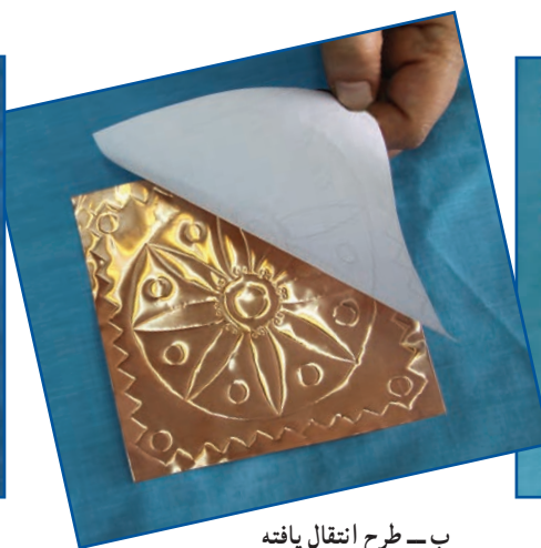
شکل ۴-۱- نحوه انتقال طرح روی ورق مسی
