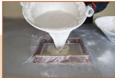
ث - ریختن ملات گچ در قالب
