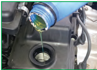
ج- به مقدار مورد نیاز، روغن به موتور بیرون کشیده و با توجه به شاخص روی درپوش مخزن روغن موتور را باز کنید. اضافه کنید. میله، مقدار روغن موتور را کنترل کنید.
