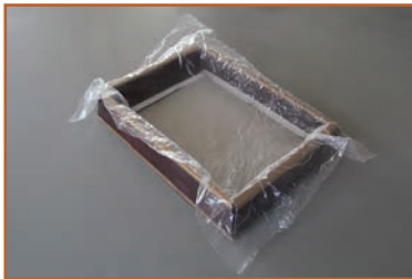
پ - قراردادن نایلون در قالب شکل ۲۰-۷ - تهیه قالب
