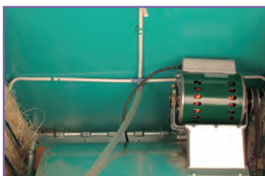
ح- آزمایش صحت مدار آب پخش کن
