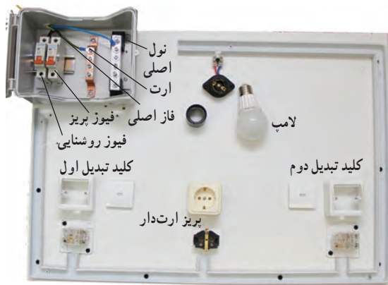
شکل ۲۰-۵- سیم‌کشی کلیدهای تبدیل
