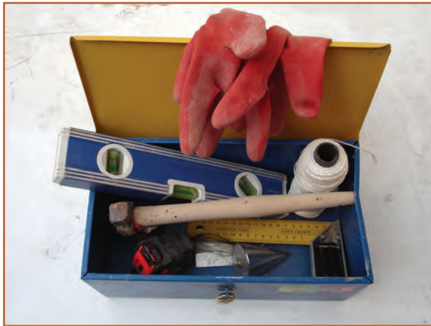
شکل ۱۰-۷- برخی از ابزار مورد نیاز دیوار چینی
