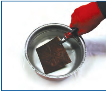
شکل ۹-۱۰- سرد کردن پلاک مسی با آب
