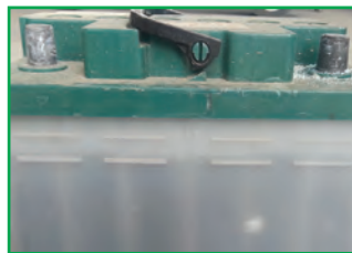
ب - به سطح مایع باتری، با توجه به شاخص‌ها، توجه کنید.
