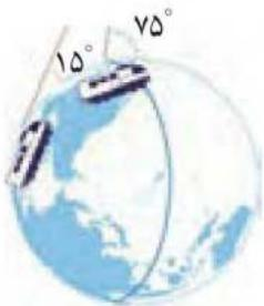
ماهواره‌ها به دور زمین در یک مسیر بسته، که آن را مدار می‌نامند، در حال گردش هستند. این مسیرها می‌توانند دایره‌ای یا بیضوی باشند، اما مرکز زمین در هر حالت در مرکز یا در نقطه کانونی مسیر آن قرار می‌گیرد. ماهواره‌ها روی سه نوع مدار که بستگی به نوع کاربرد آن دارد، قرار می‌گیرند:
