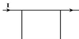
در شکل مقابل چهار ضلع مربع مقاومت‌های مشابه هستند. اگر اندازه‌ی میدان مغناطیسی حاصل از جریان ضلع بالایی در مرکز مربع B باشد اندازه‌ی میدان برآیند در این نقطه چقدر است؟
